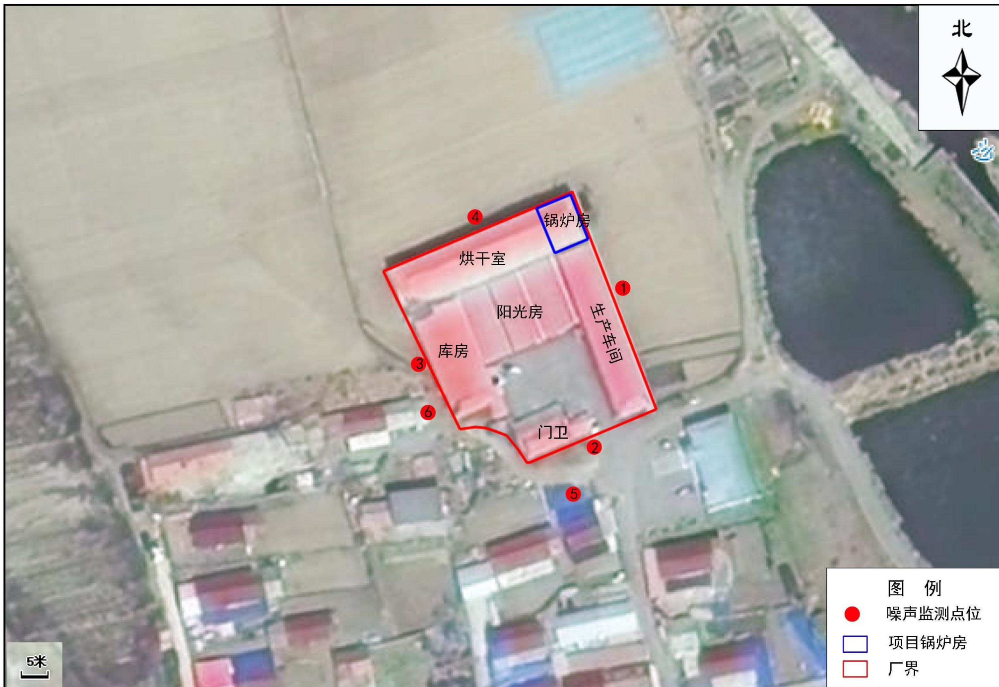
附图3 厂区平面布局及噪声监测点位示意图
